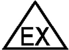
Al fine di facilitare la comprensione del segnale, al di sotto di esso devono essere riportate la seguenti indicazioni: PERICOLO ESPLOSIONE e DANGER EXPLOSION.
