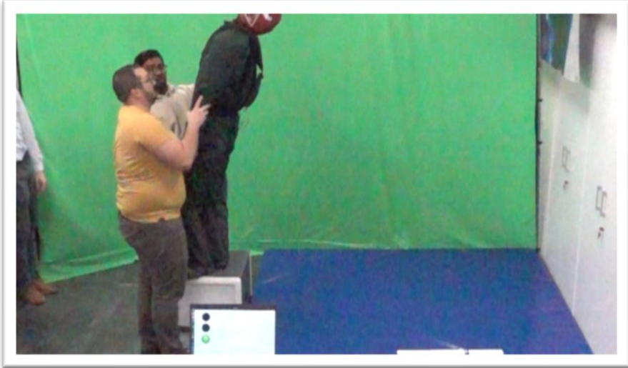
Airbag indossabile con dispositivo AI di rivelazione cadute accidentali
